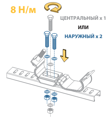
4. ПРИКРЕПИТЬ КАБЕЛЬНУЮ СКОБУ К ОПОРНОЙ ПОВЕРХНОСТИ
